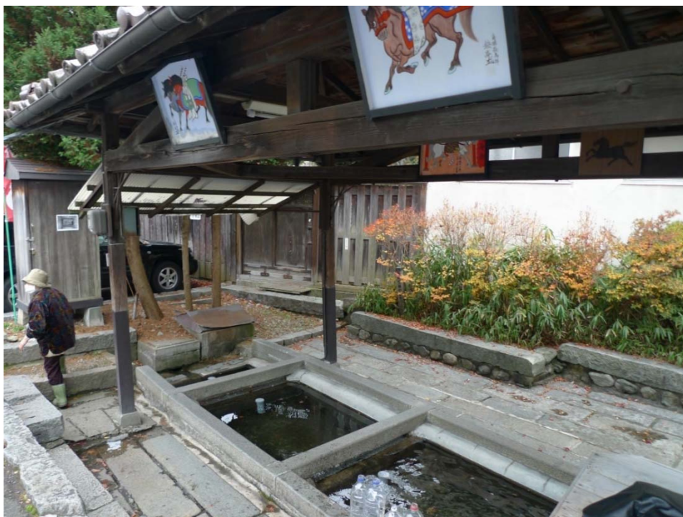
写真 11 盛岡市内で現在も使用される湧水。上流から飲用、食器洗浄用、雑用と順に使用する工夫がなされている。 2010年（平成22年）11月23日撮影
