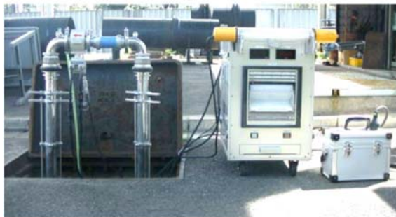
図 12 夜間流量を測定するための移動式の区画量水器
