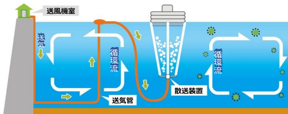
図-3.9 曝気循環施設のしくみ
