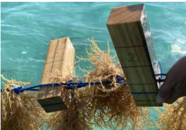
写真5:木製フロートの試験導入 海藻養殖で使用するペットボトル由来のプラスチックごみを削減するため、早生桐材による木製フロートを試験導入した。モニタリングにより、木製フロートが海藻養殖用フロートとして利用可能であることを確認し、現地樹種を活用した開発へ展開する方向性が具体化した。
