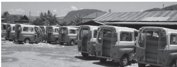
定時・定路線運行を担う14台の三輪EV。定員7人。後部はオープンで開放感がある
