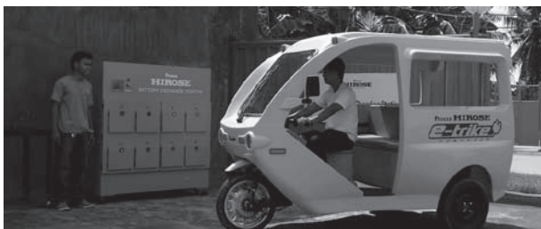
三輪EV「Pecolo」とバッテリー交換ステーション
