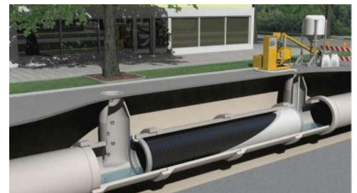
非掘削式管渠更正法の一つ
