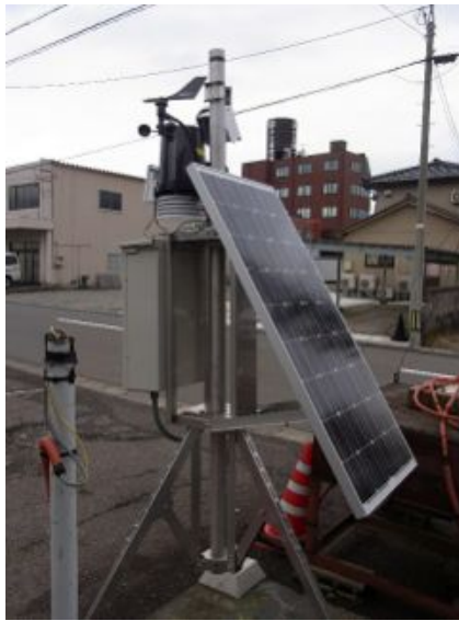
図 2-10 土砂崩れモニタリング機器（山田技研株式会社）
