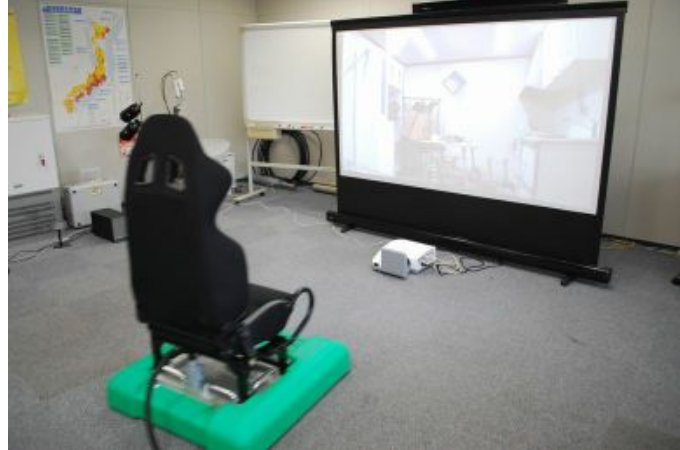
図 2-6 可搬型地震動シミュレーター（白山工業株式会社）
