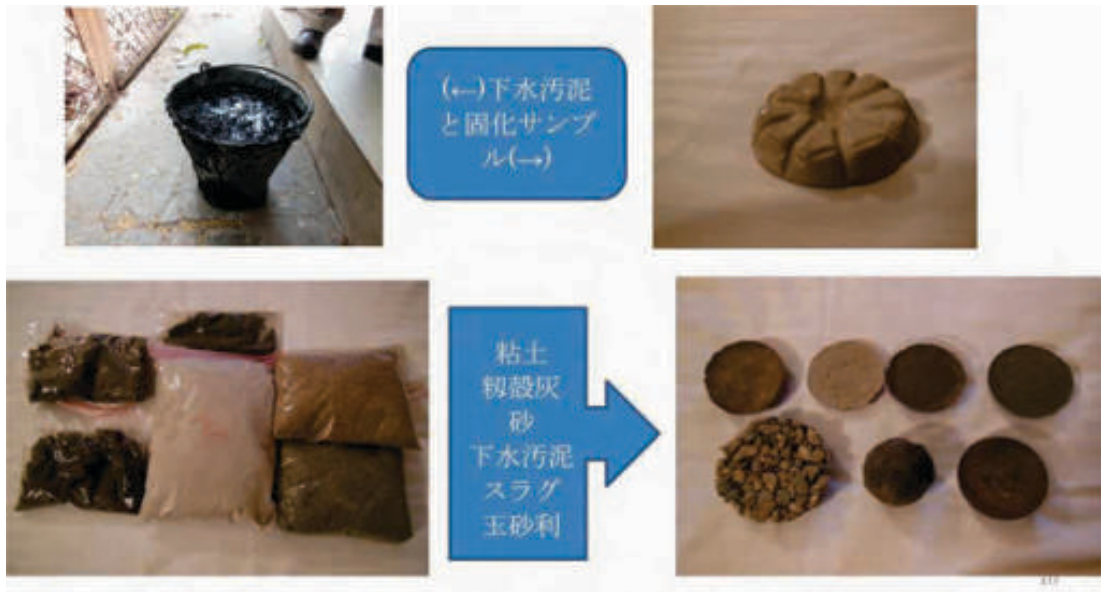
図 入手した原料サンプルとそれぞれ単独での固化試験（現地）
