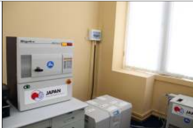
写真2：カンボジアで初めて導入された X 線回折装置(XRD)。今後は鉱業会社等からの鉱物等の分析依頼も期待され、産業界との連携が深まる事も期待される。
