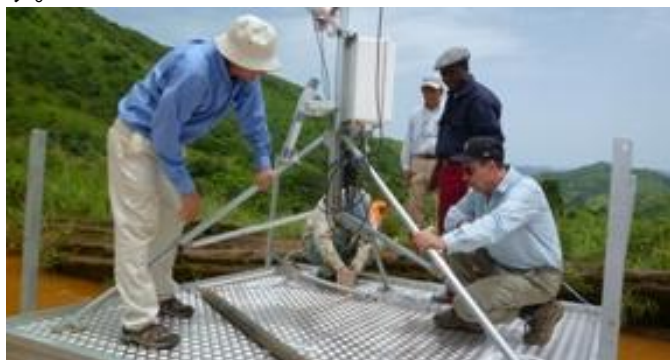
湖上の筏で調査活動を行う、カメルーン、アメリカと日本の研究者。気象観測用機材の三脚を筏のうゑに固定する。
