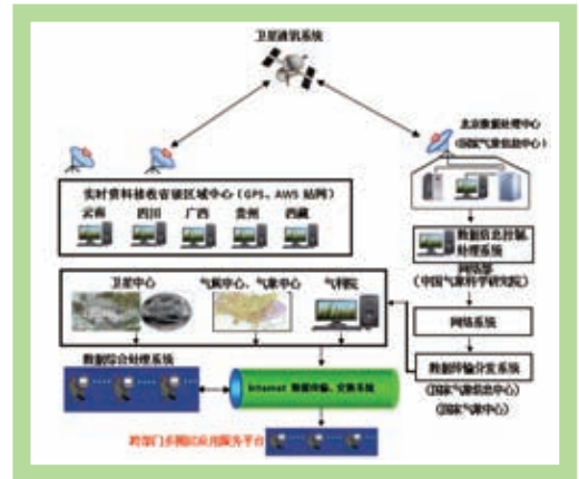
图 4 高原及东缘综合观测系统数据采集、传输和处理系统
