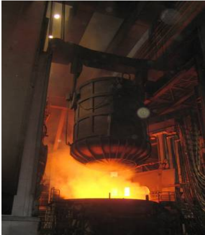
円借款資金にて調達された最新型の50t電炉
