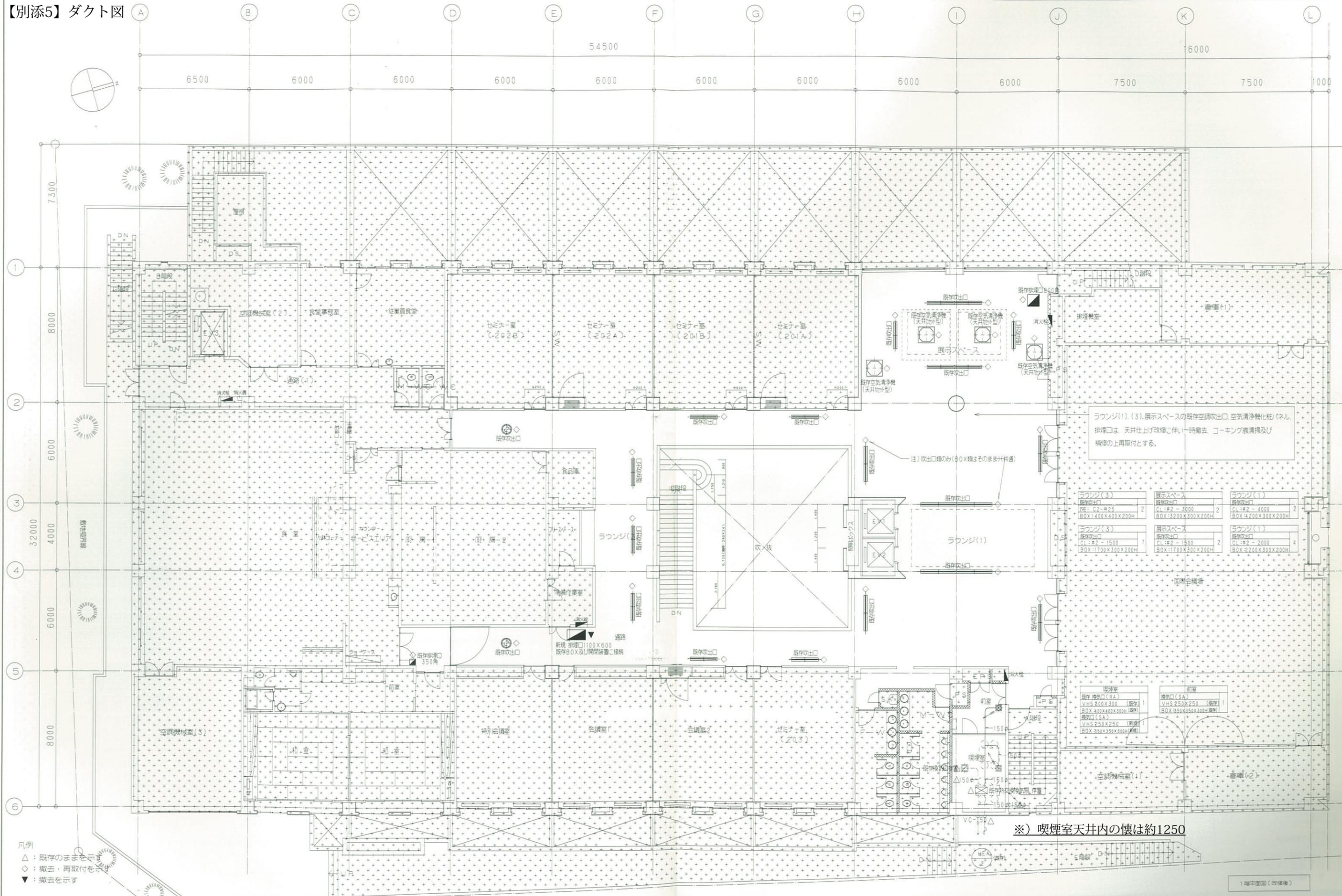
ラウンジ(1),(3),展示スペースの既存空調吹出口,空気清浄機化(パネル,排煙口は,天井仕上げ改修に伴い一時撤去,コーキング装置及び補修の上再取付とする。
