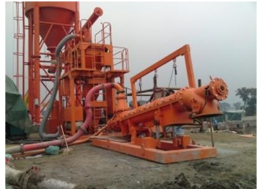
【掘削泥土再利用システム】
