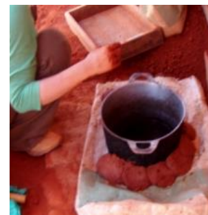
⑦ なべ した お 鍋を下に置き、 その周りに泥団子 をくっつけていき、15c mの高さまで泥で壁 を作ります
