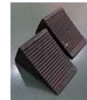
輪留めを併用する
