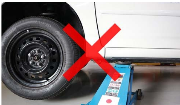
ဂျိတ်ထောက်မမည့်နေရာကို ကြိုတင်စစ်ဆေးပါ။
