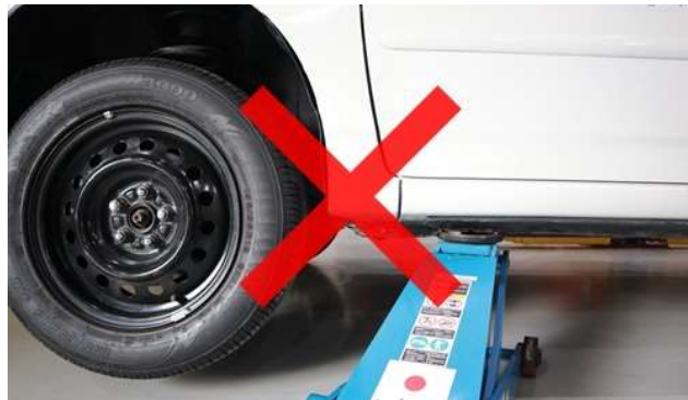
ジャッキアップ位置を 事前に確認する
