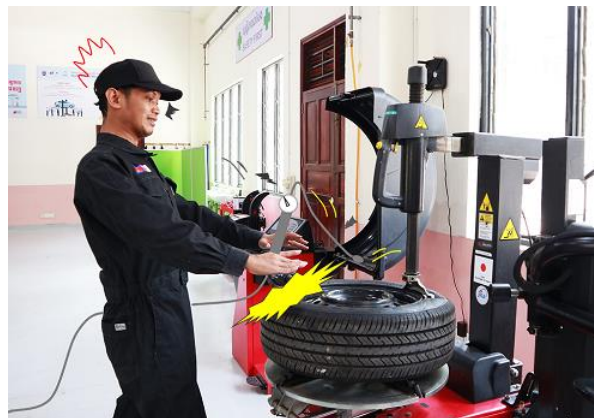
たいや ក្បឿន ជ្រុល ច្រឡំ តែ ប្តូរ បំពង់ タイヤに空気を充てん中にタイヤがバースト
