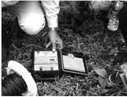
不発弾の爆破処理を行うスイッチ。 離れた場所でこのスイッチを押し、爆破処 理を行う。機械の簡易さなども指摘した。
