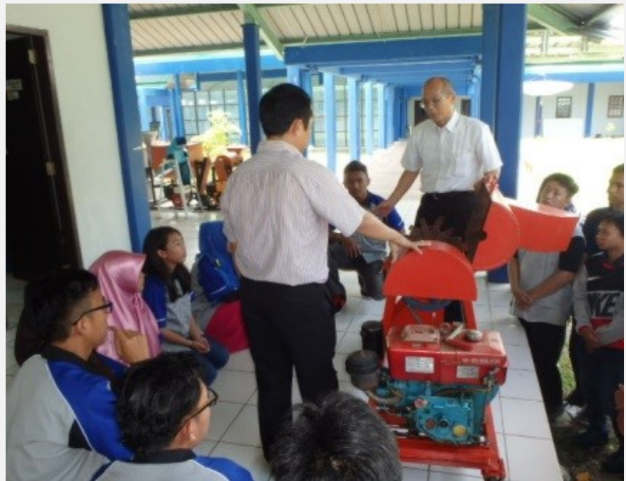
アブラヤシの種子皮粉碎機の内部を学生に示し、技術開発の着眼点を説明する宗永さん（中央右）。効率よく粉碎するため刃の形状を工夫して前年度の卒業研究で作った
