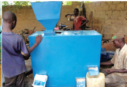
セネガルで製造された精米選別機。プロジェクトによる製造業者への指導を通じ、適正な構造を持ち、選別精度の高い国産選別機の開発が期待される
