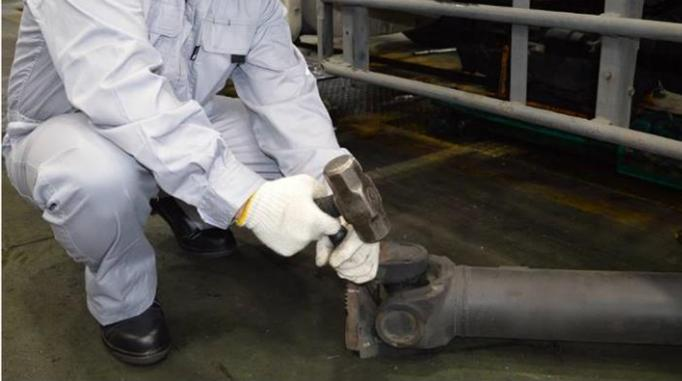
Sebuah propeler *shaft* truk besar diletakkan di atas troli barang dan dilakukan pekerjaan penggantian *spider*. Saat memukul batang pendorong dengan palu untuk mengeluarkan bantalan, jari telunjuk kanan tidak sengaja terpukul.
