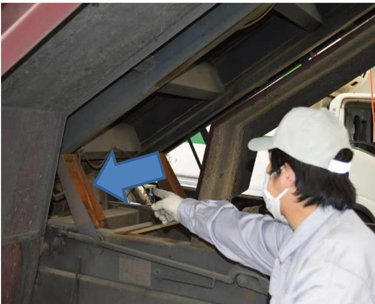
Jika pekerjaan harus dilakukan di bawah bak, pastikan untuk memasang "penahan" di antara tangki dan rangka untuk mencegahnya turun.
