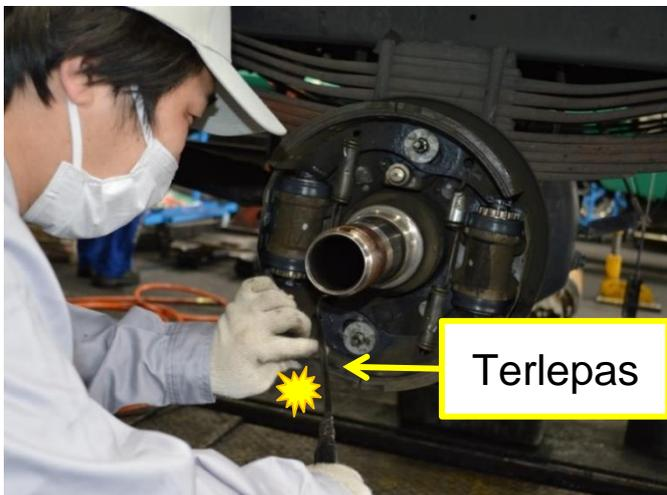
Saat melakukan inspeksi kendaraan, melakukan *overhaul* pada silinder roda dan memasang kampas rem, pemasangan pegas balik (*return spring*) tidak lancar, dan karena mencoba memasangnya dengan paksa, SST terlepas dari *spring hook*, dan tangan kirinya terbentur kampas rem dengan keras dan terluka.
