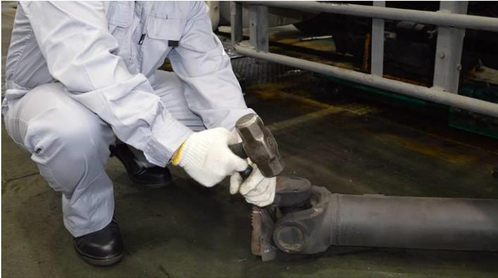
ကုန်တင်ကားကြီး၏ Propeller shaft တစ်ခုလုံးကို တွန်းလှည်းပေါ်တွင် တင်၍ Spider လဲလှယ်ခြင်း လုပ်ငန်းကို လုပ်ဆောင်နေသည်။ Bearing ကို ဖြုတ်ရန်အတွက် ထောက်တံကို တူဖြင့်ထုနေစဉ် ညာဘက် လက်ညှိုးကို မတော်တဆ ထုမိခဲ့သည်။
