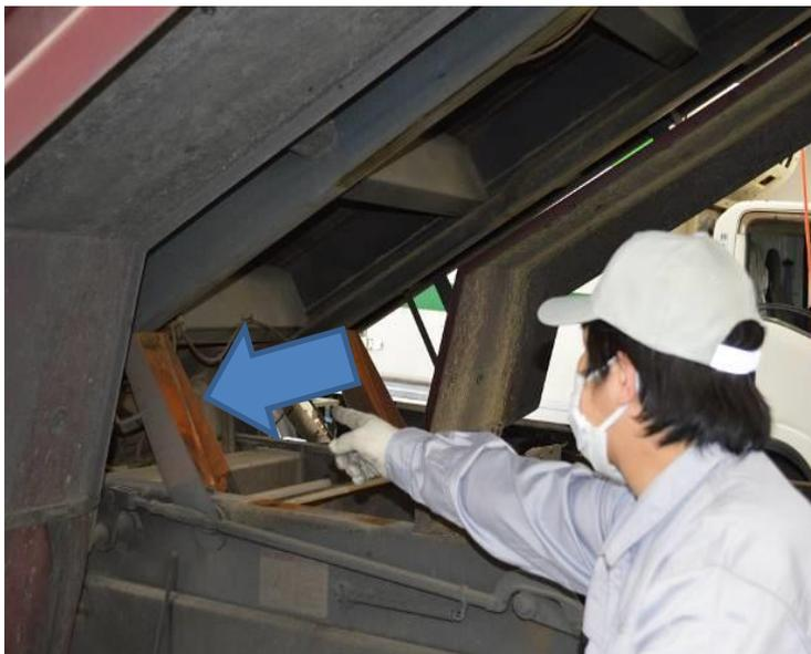
やむを得ずベッセルの下で作業をする場合は、必ず、「ストッパ」をベッセルとフレームの間に入れ、下降防止を図る。
