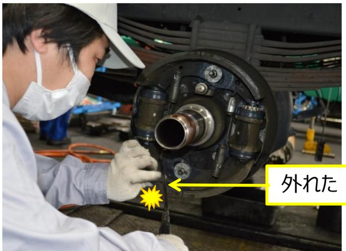
車検作業中、ホイール・シリンダをオーバーホールしてブレーキ・シューを取付ける際にリターン・スプリングが上手く掛からず、無理に取付けしようとしたため、S S Tのバネ掛けが外れ、左手をブレーキ・シューに強打し負傷。
