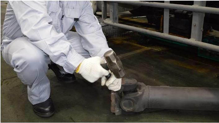
大型トラクタのプロペラシャフト単体を台車の上に置いて、スパイダの交換作業を実施。ベアリングを抜くため、当て棒をハンマでたたいた際、誤って右手人差し指をたたいてしまった。
