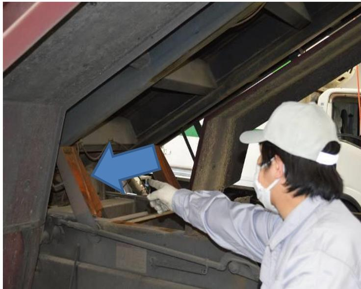
Nếu không tránh được phải làm việc dưới thùng xe, hãy đảm bảo chèn bằng “miếng chặn” giữa thùng xe và khung để đề phòng thùng xe bị hạ xuống.
