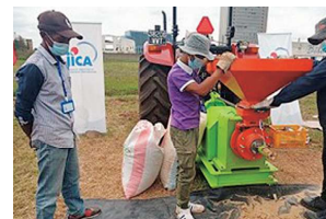
もみ殻を固形燃料化する作業
