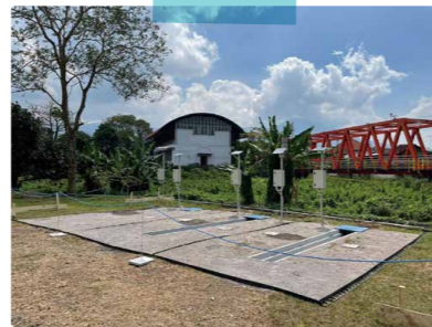
軟弱地盤でのポラスコンクリート 製品性能試験の様子
