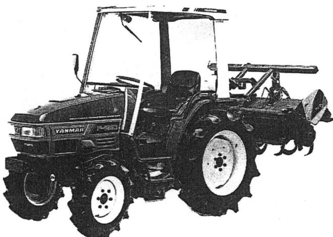
図3-37 ヤンマー製 F220形トラクタ（2柱式安全フレーム装着）
