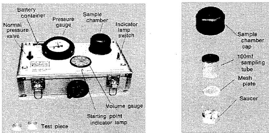
Fig. II -2-4 Three Phase Meter
