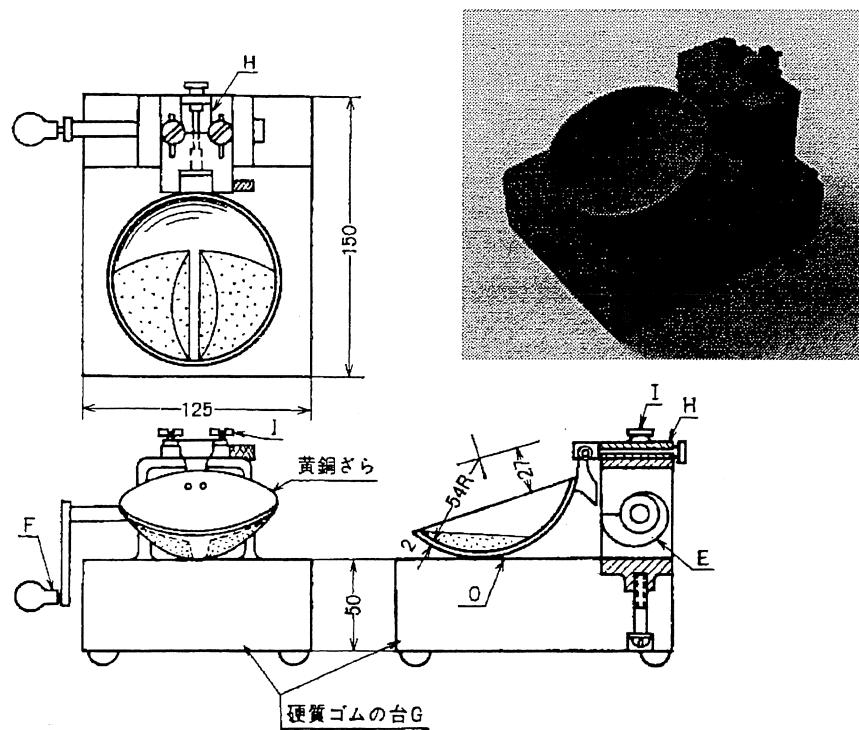
Fig. II-3-3 Liquid Limit Tester
