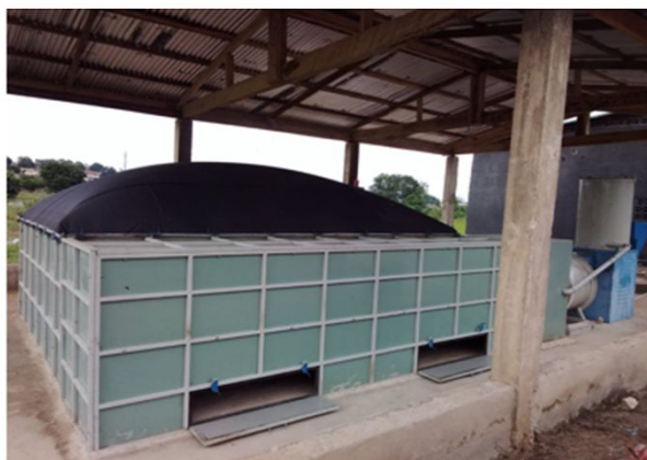
LOCAGRI (Agboville) 乾燥室カバーをかけ風向を変更（穀層の上から下へ）して運転している状態
