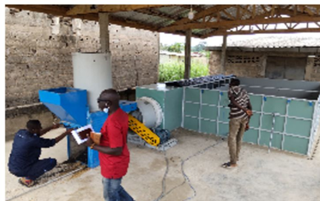
RRB (Tiassalé) 穀殻を燃焼させ、送風（穀層の下から上へ）している状態
