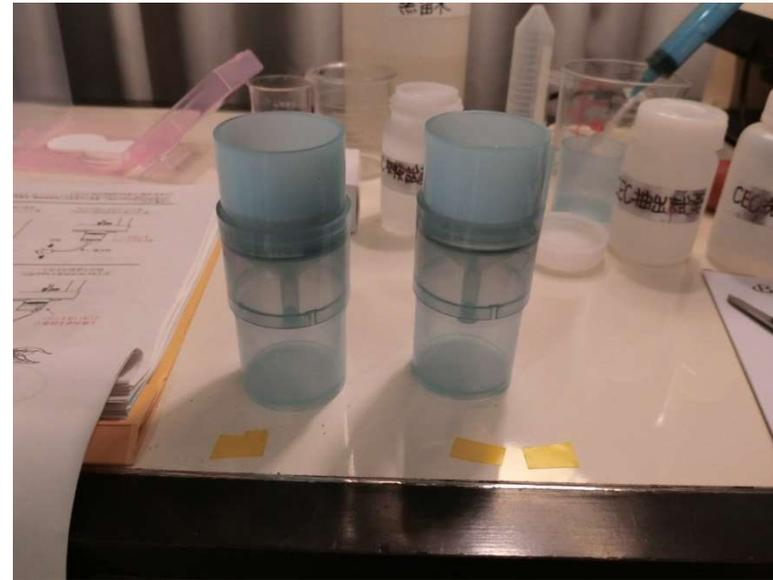
陽イオン交換容量 (CEC) 測定水作成 交換→洗浄→抽出
