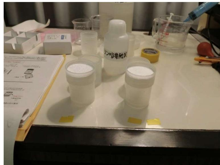
リン酸吸収係数測定用サンプル水作成
