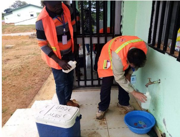
Prélèvement des eaux par l'entreprise pour analyse physicochimique (Contenants provenant du Centre Pasteur)
