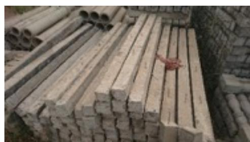
図 4-2 鉄筋コンクリートの杭
