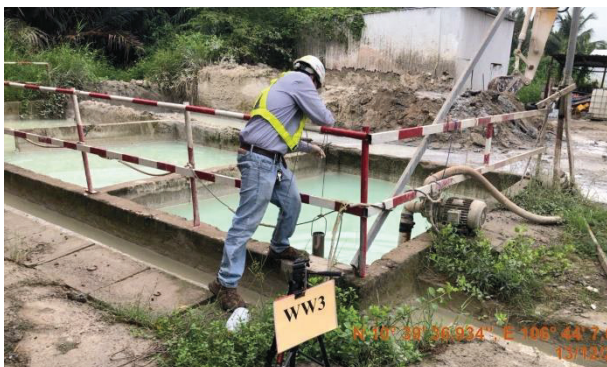
Wastewater sampling at WW3 / Thu mẫu nước thải tại WW3
