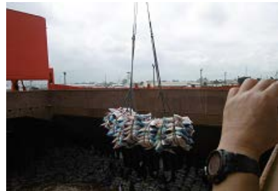
f) ライスバッグ1組の荷揚げ(ホールド→岸壁)
