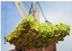
図 2.1-10 吊荷姿 E 420 バッグ (15 バッグ x 2 列 x 7 セット x 2 組) 重さ 21 トン
