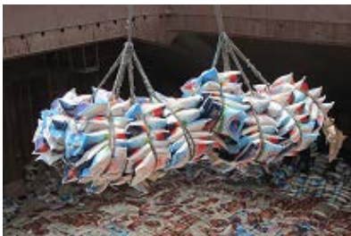
図 2.1-8 吊荷姿 C 180 バッグ (15 バッグ x 2 列 x 6 セット) 重さ 9 トン
