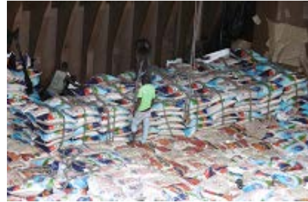
d) ライスバッグ1組へのロープの玉掛け
