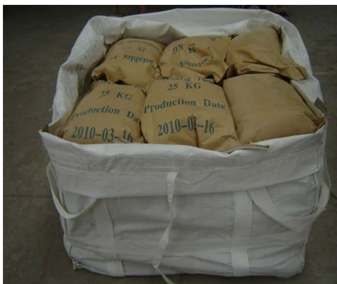
図 6.2-7 大型バッグへの小袋の詰め合わせ例
