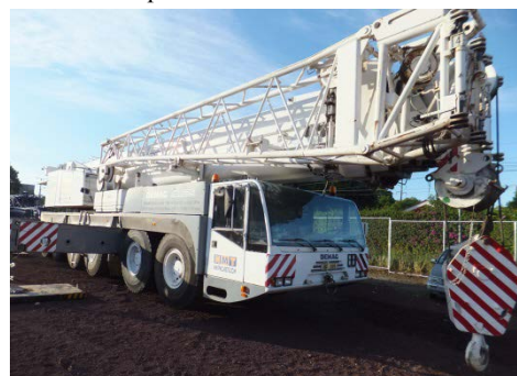
Camión Grúa de 100t
