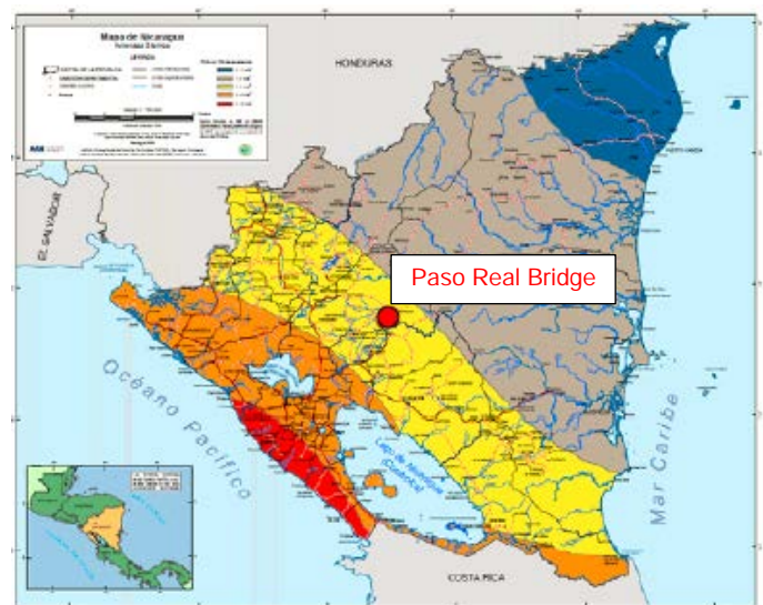
Figura 2-2.2 Coeficiente sísmico horizontal de diseño de Nicaragua (superficial)
