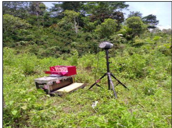
Gambar 8. Pengukuran kualitas udara ambien dan tingkat kebisingan di lokasi tapak proyek.
