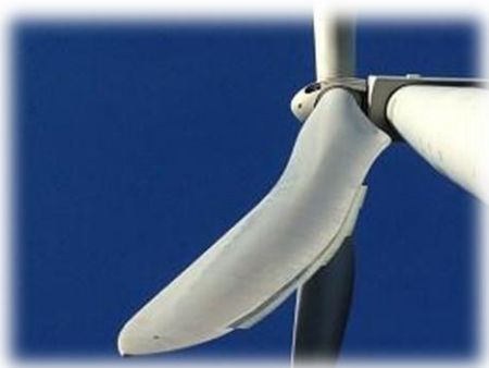
ຮູບທີ 3-7: ຕົວຢ່າງການຕິດຕັ້ງ Low-Noise-Trailing-Edges (LNTEs) ທີ່ຂອບໃບພັດ.
