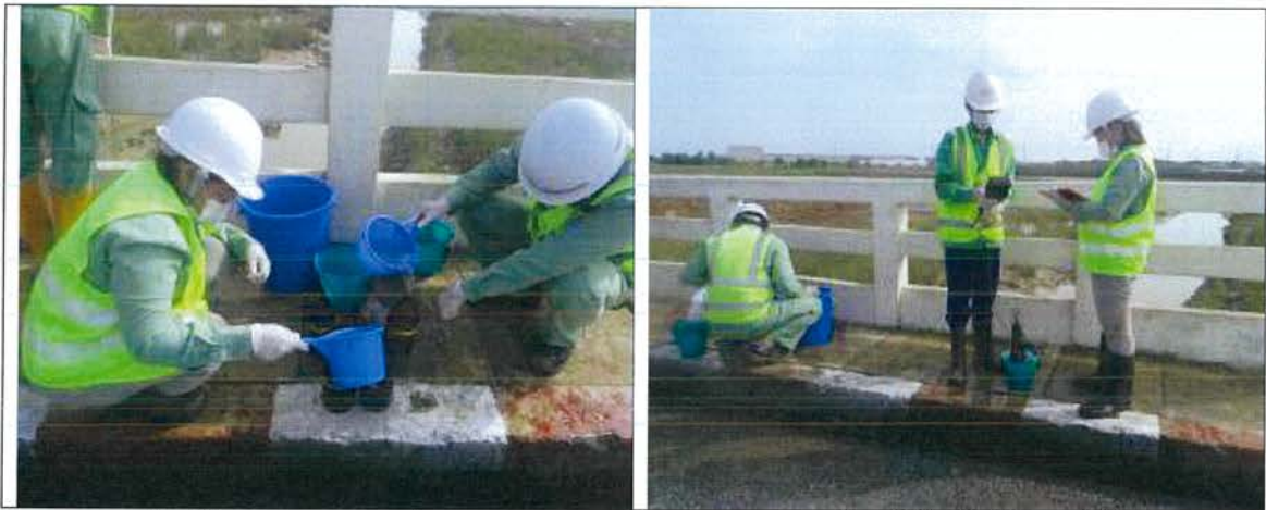
မြေပေါ်ရေ နမူနာယူသည့်နေရာ-၄ (SW-4) ၌ ရေနမူနာကောက်ယူခြင်းနှင့်တိုင်းတာခြင်း
