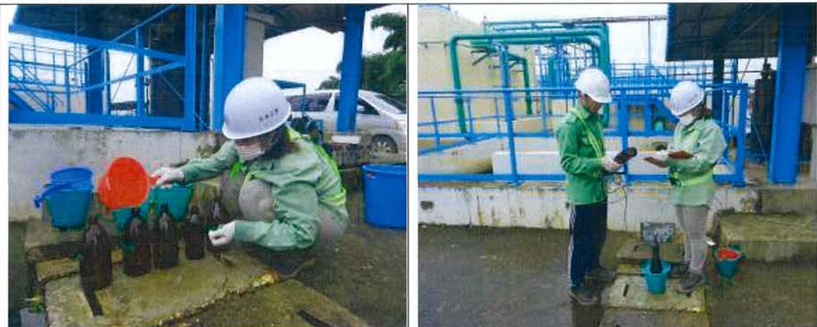
မြေပေါ်ရေ နမူနာယူသည့်နေရာ-၆ (SW-6) ၌ ရေနမူနာကောက်ယူခြင်းနှင့်တိုင်းတာခြင်း
