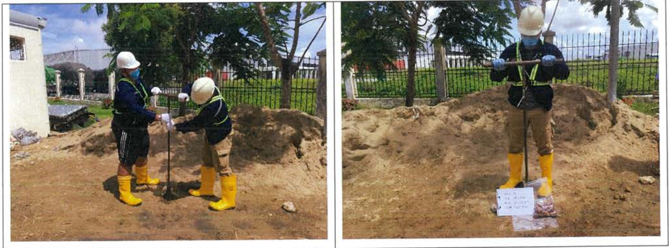
ပုံ-၂ S-1နေရာတွင်မြေသားနမူနာကောက်ယူနေပုံ
