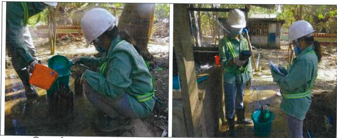
မြေအောက်ရေ နမူနာယူသည့်နေရာ-၁ (GW-1) ၌ ရေနမူနာကောက်ယူခြင်းနှင့်တိုင်းတာခြင်း
