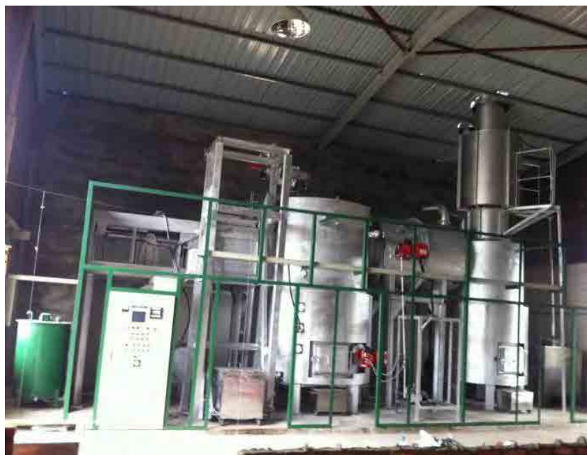
図表.17 本事業において製造した医療（感染性）廃棄物処理用の焼却炉
