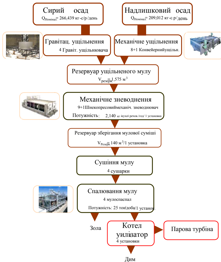
Рис. 6-2. Загальна схема технічних процесів обробки та утилізації осаду
