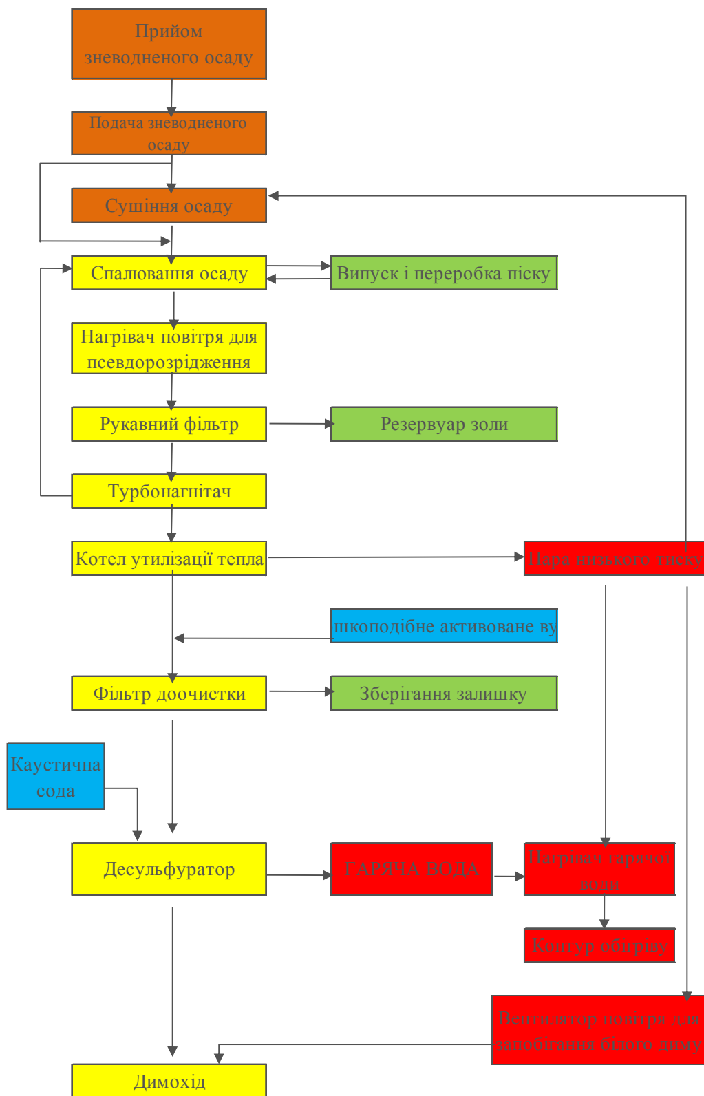
Рис. 6-3. Діаграма термічної утилізації осаду
