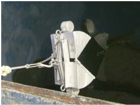
Figure 70: Types de Bennes Van Veen qui sera utilisée pour le prélèvement des sédiments de surface
