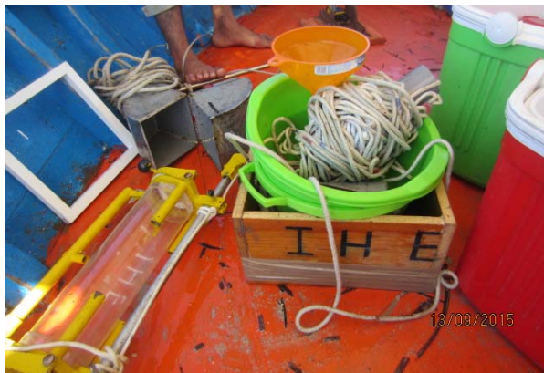
Figure 69 : Bouteille hydrologique de prélèvement d'eau et équipement de mesures in situ
