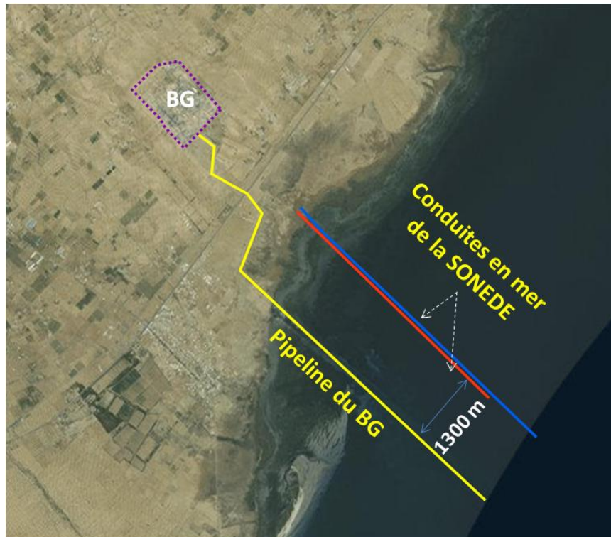
Figure 160 : Situation des conduites en mer de la SONED par rapport au pipeline du BG
