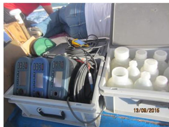
Figure 69 : Bouteille hydrologique de prélèvement d'eau et équipement de mesures in situ
