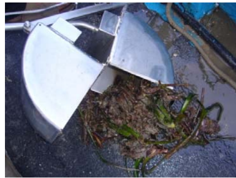
Figure 70: Types de Bennes Van Veen qui sera utilisée pour le prélèvement des sédiments de surface
