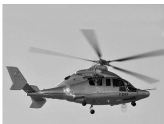
Eurocopter X3 Velocidad máxima: 472 km/h.
