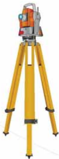
セオドライトは、工学活動で使用される垂直角と水平角を測定するための機器です。
