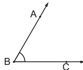
1. Usando una abertura cualquiera del compás, se hace centro en B y se traza un arco que corte los lados del ángulo en dos puntos D y E.
