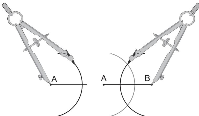
3. Se marcan los puntos de intersección de los dos arcos y se traza la  $\vec{l}$  que pasa por estos puntos.
