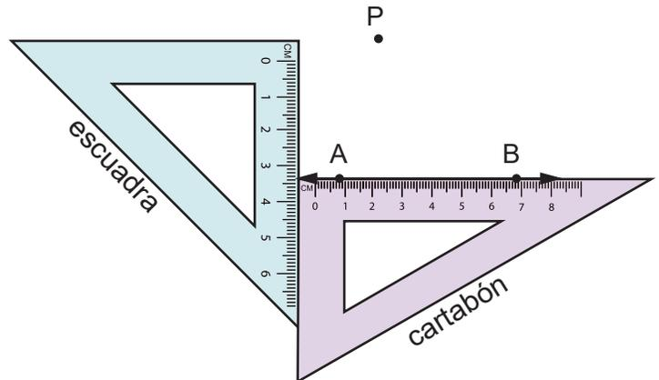
2. Se desliza el cartabón hacia arriba hasta alcanzar el punto P sobre el cual se traza la paralela a la  $\overleftrightarrow{AB}$ .
