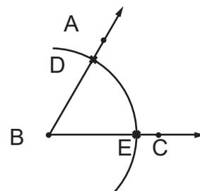
2. Se abre de nuevo el compás, se coloca su punta metálica primero en D y se traza un arco en el interior del  $\angle ABC$ ; para E se procede igualmente, conservando la misma abertura del compás.
