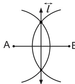
Se usa el transportador para comprobar que la medida del ángulo que forman la  $\vec{l}$  y el  $\overline{AB}$  es  $90^\circ$ .
