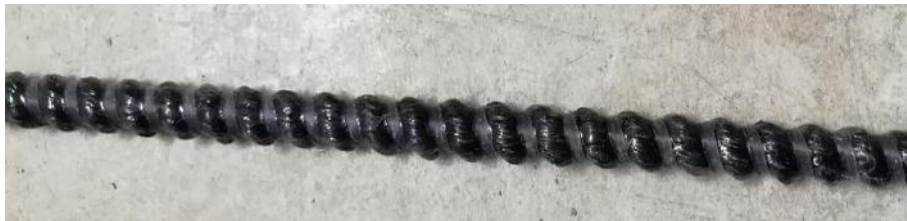
Fig: CF RTS bar( \varnothing = 8 mm)
