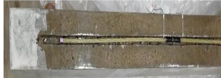
Fig: Applying Primer and NSM CFRP bar
