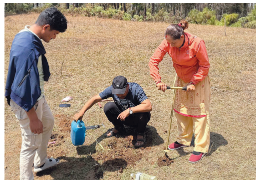
स्याङ्जामा नवीकरण गर्नुपर्ने पोखरीको गहिराई पहिचान गर्न हाइड्राउलिक कन्डक्टिभिटी परीक्षण
