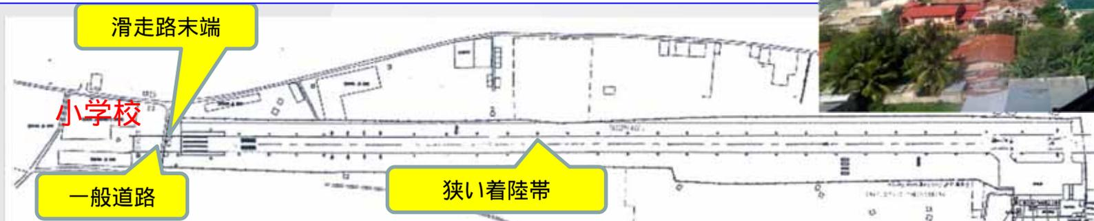
旅客ターミナルと滑走路の間隔が近すぎ、飛行機同士の接触の恐れ。
