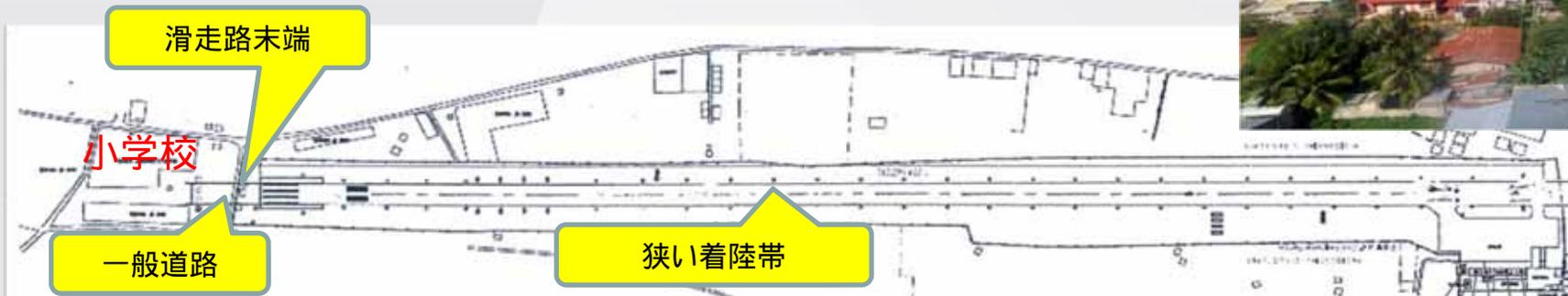
旅客ターミナルと滑走路の間隔が近すぎ、飛行機同士の接触の恐れ。
